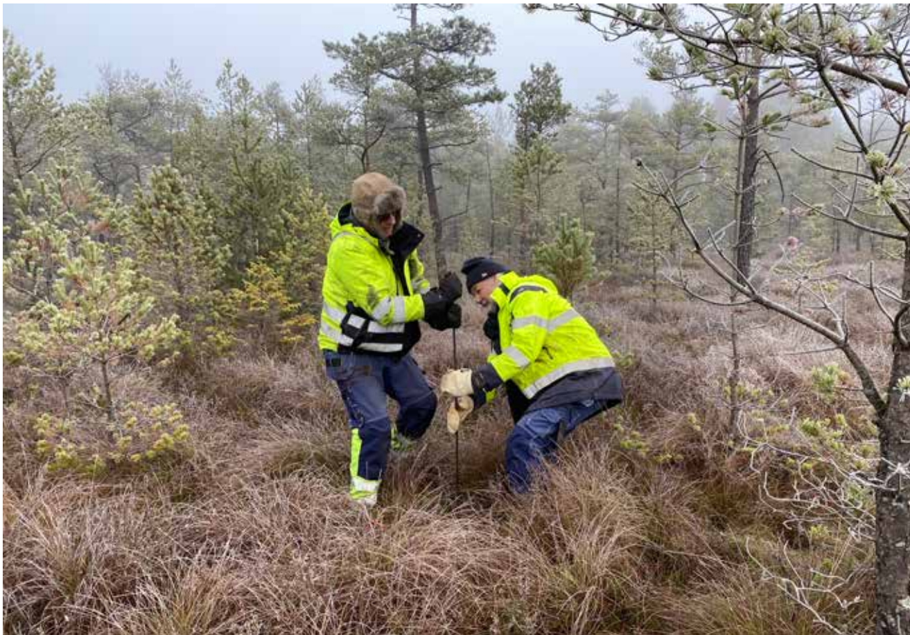
Figur 3. Mossens djup kontrolleras med hjälp av det specialgjorda verktyget, två stycken två meter långa armeringsjärn som kan skruvas ihop till en fyra meter lång provsticka.
