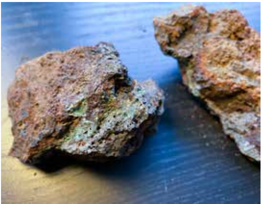
Figur 7. Slagg med ett tydligt grönt skikt av kopparoxid. Foto: Annie Rosén
