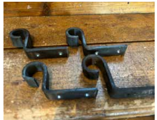
Rekonstruerade nya askledarfästen i smide lika de som satt på taket.
