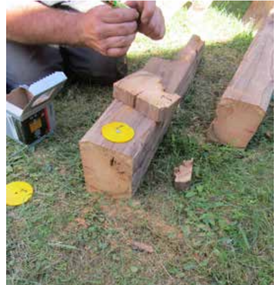
Uttagning av sågskiva för dendroprover ut ett stödben (prov 1).
