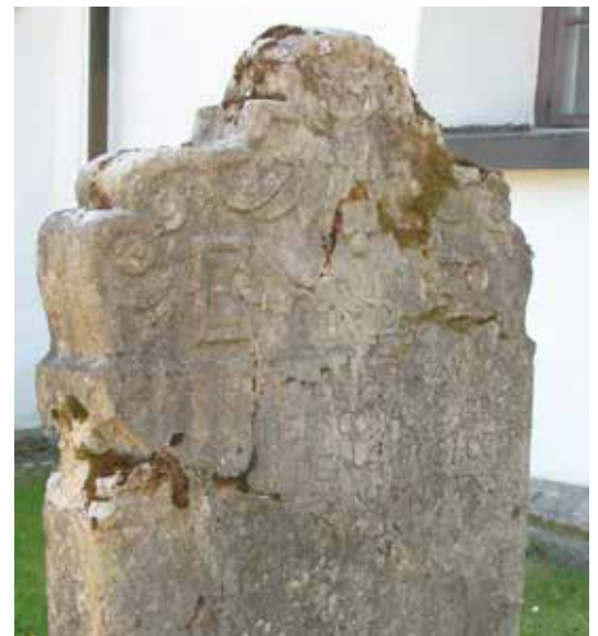
Kalksten har en förmåga att spjälka sig och spricka. Denna sten på Forserums kyrkogård i Nässjö kommun kräver insatser av en stenkonservator.
