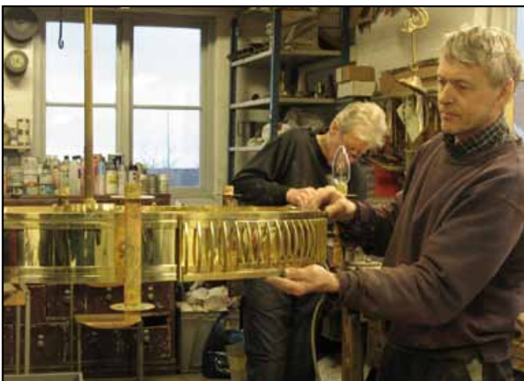
Gelbgjutare Bertil Fong i Gränna under arbetet med en av de nya ljuskronorna till koret. Utprovning av den rasterdekor som inspirerats av Sankt Lars’ halster, symbolen för Svarttorps gamla kyrka. Till höger en av de färdiga kronorna monterade i koret. Inre belysningsring ej tänd.
