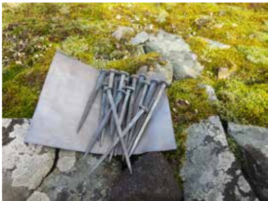
Nyttillverkad smidd spik till infästningen.
