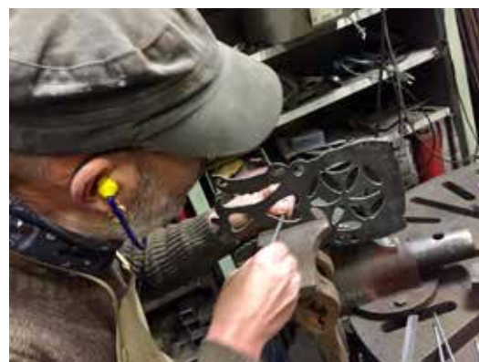
Kanterna på den nya flöjeln efterbearbetas efter vattenskriningen av dekoren av smeden Roland Svensson. Foto Roland Svensson.
