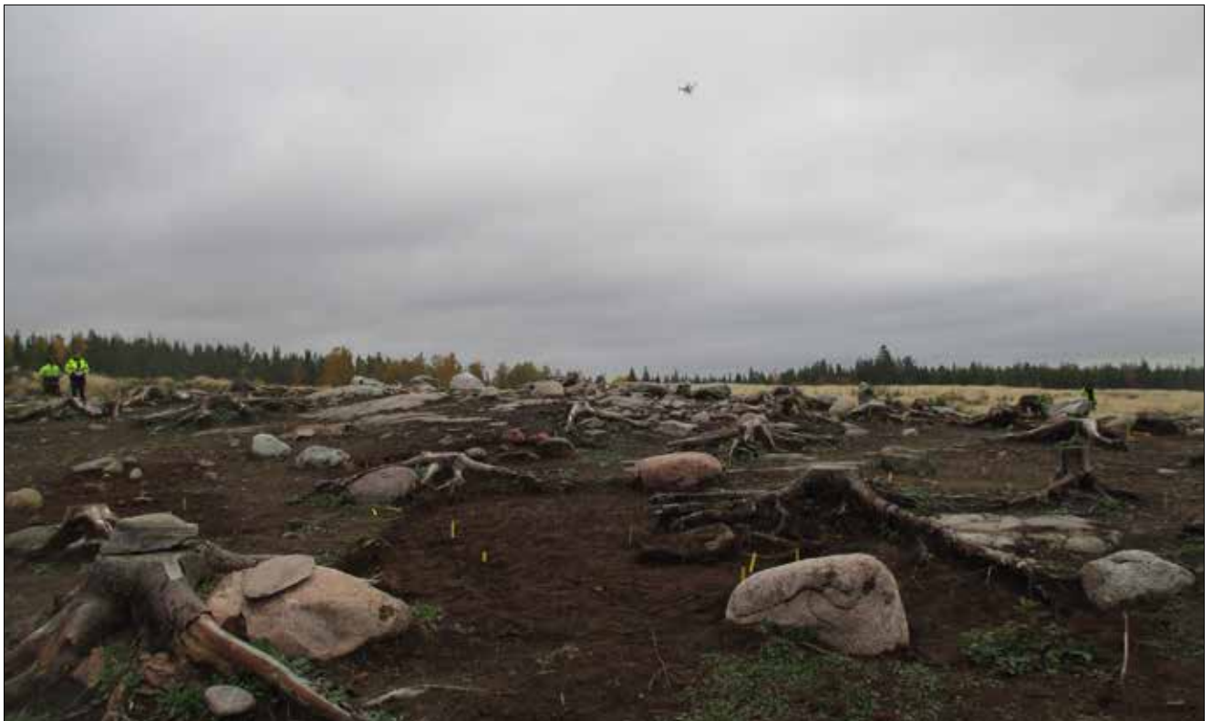
Figur 4–5. Inmätning och dokumentation med nätverks-RTK och drönare.
