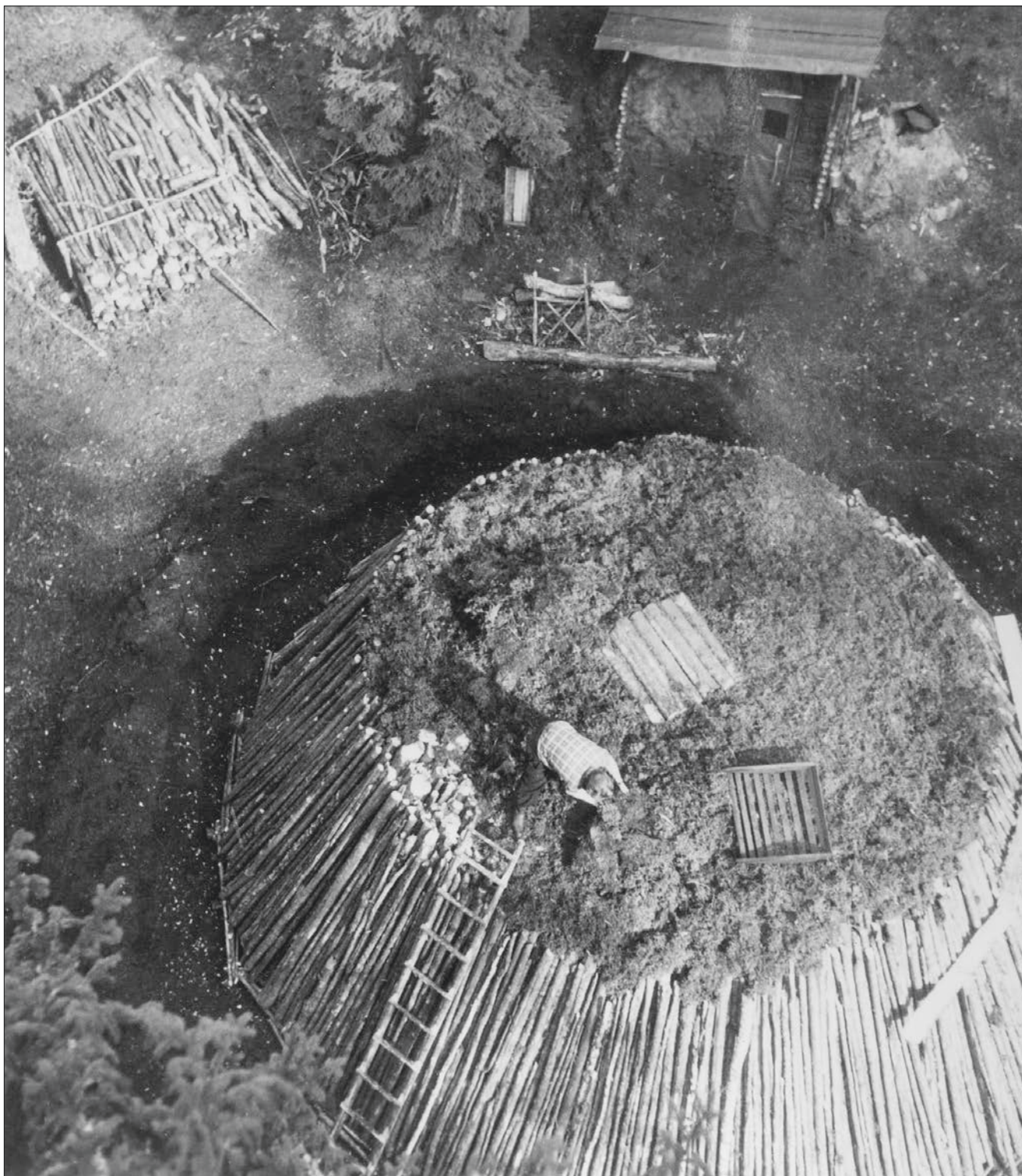
FIGUR 5. Innan milan täcks med kolstybb läggs mossa på kullen. Gammelkroppa Skogsskola, Värmland 1941. Från Skogsbibliotekets bildarkiv, filnamn Ly-633.
