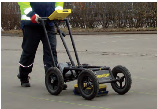
FIGUR 6. Georadar typ Sensors & Software NogginPlus 500 MHz med Smart Cart. Den typ av teknisk utrustning som utnyttjats vid kartering av Jönköpings slott 2010 - 2011. Foto : Kennet Stark.
