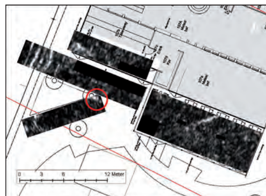
FIGUR 8. Anomali belägen inom söder om byggytan på ett djup av ca 0,85 m. Sannolikt del ingående i kurtinmur eller gevärgalleri.
