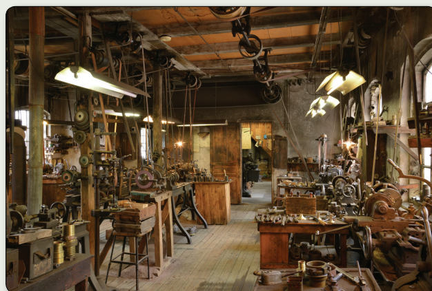
Interiör från verkstaden med maskinutrustning och remdrift, huvudsakligen från 1920-talet. Foto Jönköpings läns museum.
