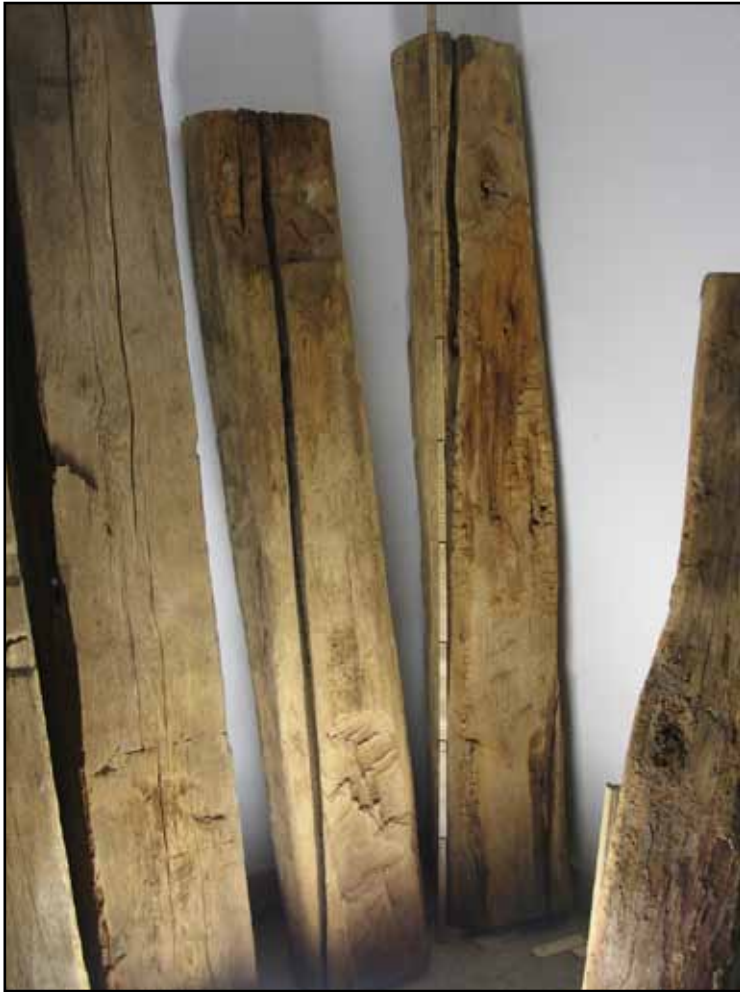
Den itusågade ekbjälken i bildens mitt är en halvklova, virket är fällt någon gång efter 1238. Till vänster fyrkantshuggen bjälke från ca 1509.
