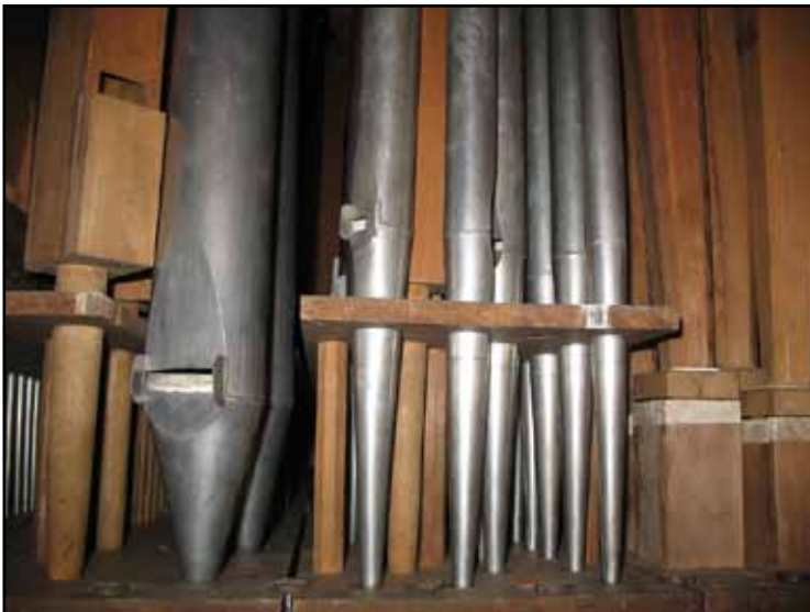
Blick in genom vänstra sidoluckan. Från vänster: Trumpet 8' (1839), Qvinta 3' (1839), Fugara 4' (1895), Principal 8' (1895), Fleut amabile 8' (1839), Octava 4' i fasaden (1839). Erik Nordströms tillskott medförde att utrymmet för piporna begränsats kraftigt. Nedan blick in genom högra sidoluckan.
