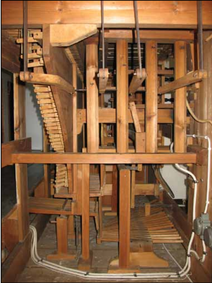
Spel- och registreringsmekaniken sedd från vänstra luckan, merparten är intakt från Sven Nordström. Observera självjusteringsanordningen från 1942.
