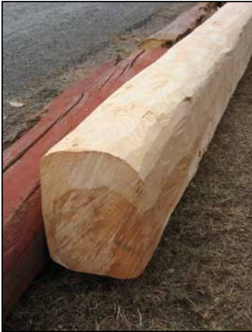
Tätväxt Hökensåstimmer, utsynat på plats användes till lagningarna.
