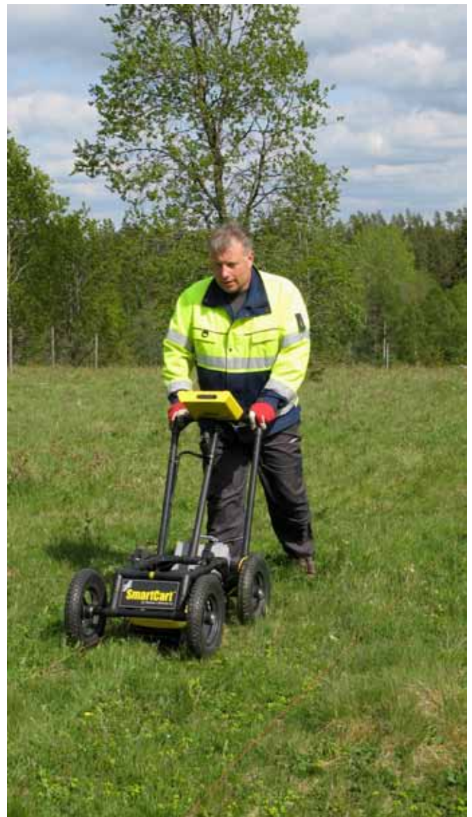
FIGUR 17. Lasse Winroth kör georadar på den forna kyrkplatsen i Jära by. Foto: Claes B Pettersson, Jönköpings läns museum.
