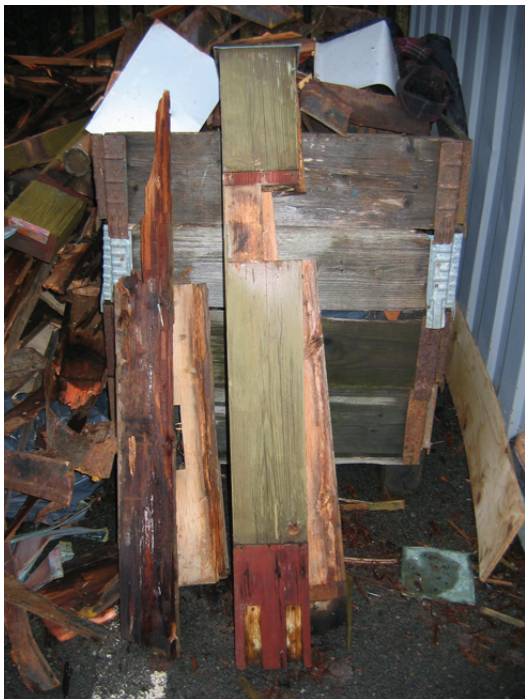
Delar av det rötskadade korset över sidoentrén bar spår av tidigare färgskikt.
