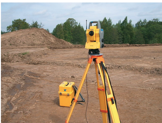
FIGUR 6. Anläggningar, rutor, fynd, prover och schakt mättes in med totalstation. Foto: Max Magnusson.
