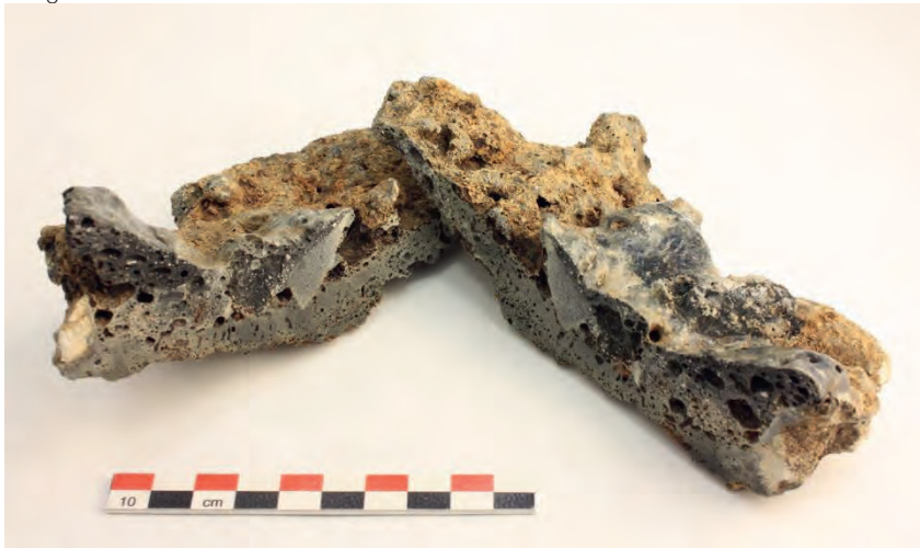
Figur 2. Den delade smidesskållan 1 där överytan är fluten och glasig med stora porer. Tvärsnittet visar en i undre delen småporig grå-mörkgrå slagg. I övre delen av slaggen finns ett stort inslag av bergartsfragment i ett glasigt matrix.
