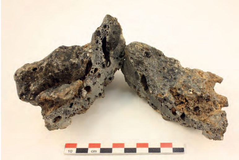
Figur 3. Skålla 2 har en överyta som är ojämn, fluten och glasig och har inslag av bergartsfragment. Den ses i tvärsnitt bestå av en tämligen homogen slagg mot botten. Mot överytan har slaggen ett stort inslag av bergartsfragment.
