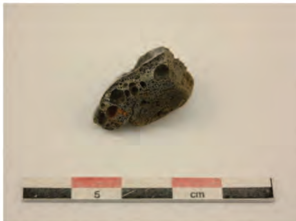
Fnr 800, den tekniska keramiken i tvärsnitt. Den smälta glasiga delen i vänstra övre delen och den brända leran i högra nedre delen.
