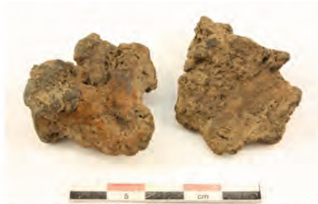
Fnr 772, de båda slaggerna i fyndposten. Slaggen till vänster med urskiljbara slagglöden; den till höger med en plan avtrycksyta.
