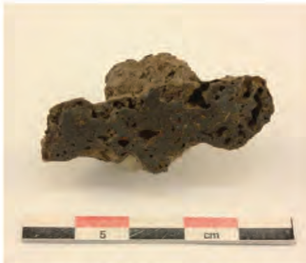
Fnr 771, delad slagg. I tvärsnitt homogent uppbyggd slagg med en del större porer.
