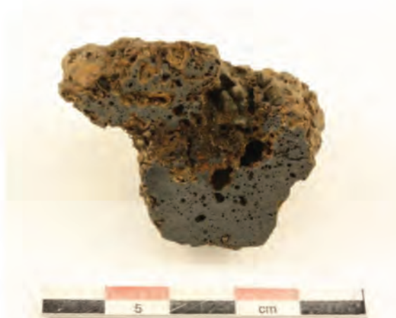
Fnr 801, delad slag. I tvärsnitt homogen i sammansättning men en skillnad i porositet antyder att den nedre delen är tät eller småporig slagg och den övre har inslag av större hålrum.
