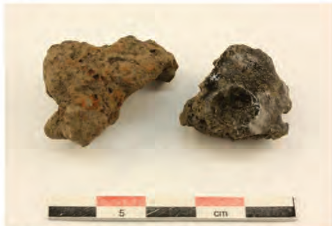
Fnr 800, slagg till vänster och teknisk keramik till höger.
