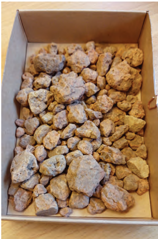
FIGUR 10. Bränd lera i urval från eldstadskonstruktionen, fjärde kvadranten.
