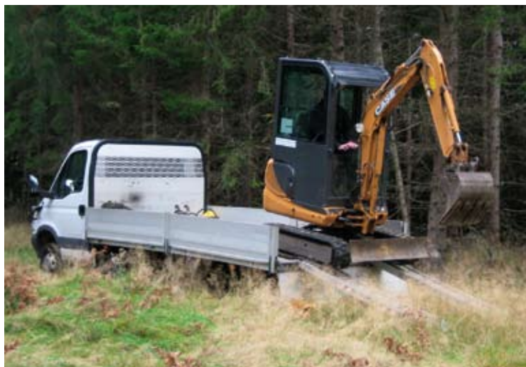
FIGUR 2. På några av objekten användes en minigrävare för att dra upp rotvältor och rensa bort ris och sly.
