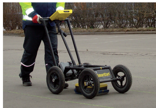
FIGUR 6. Georadar typ Sensors & Software NogginPlus 500 MHz med Smart Cart. Den typ av teknisk utrustning som utnyttjats vid kartering av Jönköpings slott 2010. Foto : Kennet Stark.
